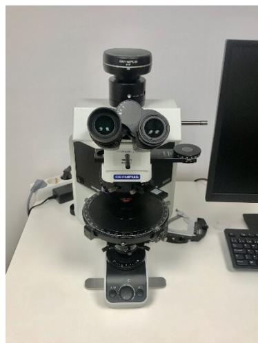
por el software. Los ajustes del microscopio se pueden guardar automáticamente con cada imagen, lo que facilita la reproducción de los ajustes en un momento posterior y proporciona documentación para la elaboración de informes. Tiene objetivos de 10x, 20x, 30x y 40x aumentos.
